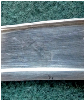
Fot. 5. Pęknięcie po naprawie
